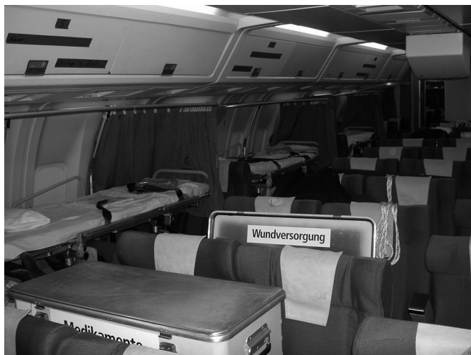
Abb. 2 Eine Boeing 767 der Condor oder Lufthansa kann innerhalb von wenigen Stunden mit 20 Stretchern ausgerüstet werden. Daneben stehen 30 Business-Class-Sitze für Liegendtransporte zur Verfügung. Bis zu 10 Beatmungsplätze können betreut werden. Das Flugzeug erreicht ohne Zwischenlandung die meisten fernen Destinationen. Somit bietet ein Linienflugzeug unter Betreuung durch den Medizinischen Dienst der Deutschen Lufthansa AG die derzeit größte Transportkapazität für einen Massenansturm von Verletzten.
