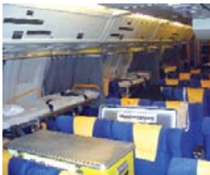
An Bord eines Großraumflugzeugs der Lufthansa können bis zu 20 Flugkrankentragen und 30 Businessclass-Sitze für Liegendtransporte genutzt werden. Daneben ist das Monitoring von zehn Beatmungspatienten möglich.
