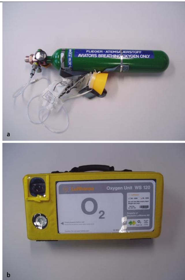
**Abb. 7** ▶ „Alter“ und der „neuer“ Sauerstoff. **a** Fliegersauerstoff für die Versorgung der Flugbesatzung bei Druckabfall der Kabine, nur im medizinischen Notfall für die Patientenversorgung verfügbar. **b** Im Voraus buchbar: System Wenoll WS 120, Carbonflasche und Demandventil mit Versorgungszeiten bis ca. 16 h und fest installiertem Pulsoxymeter. (Bild: nach Taschenbuch Flugmedizin [20], mit freundl. Genehmigung)
